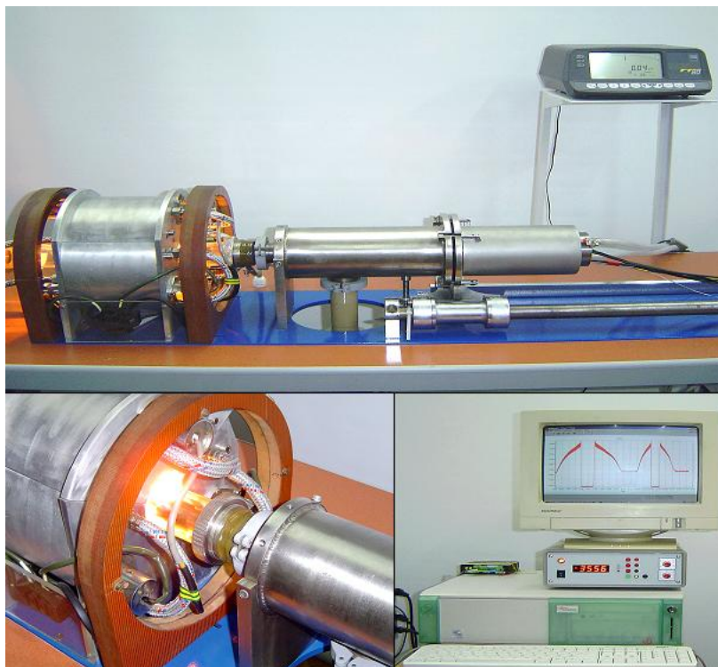
Rys. 2. Fotografia termoanalizatora-dylatometu w wersji umożliwiającej detekcję efektów termomechanicznych w systemach podłoże - powłoka PVD.
