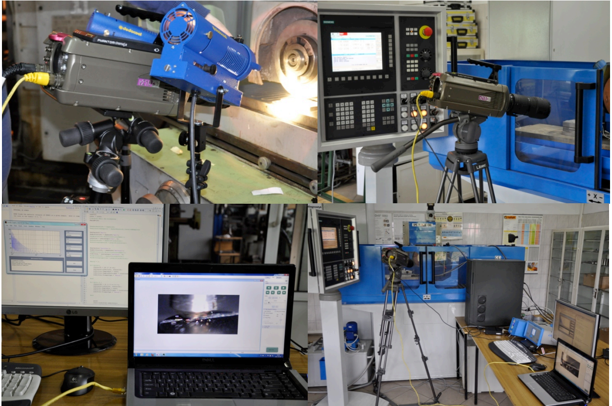
Stanowisko do akwizycji obrazów szybkozmiennych podczas procesu mikroskrawania stopów tytanu.
