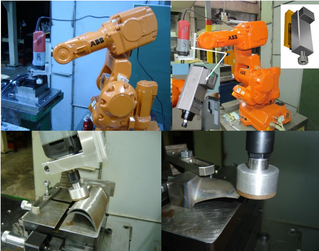
Rys. 19. Widok ogólny stanowiska badawczego wyposażonego, oraz obrabiane łopatki turbin silnika lotniczego
