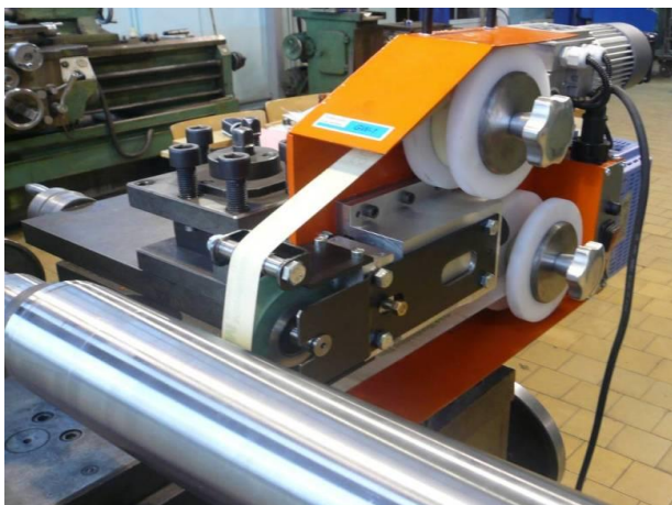
Rys. 22. Mikrowygładzanie powierzchni walcowej foliową taśmą ścierną z zastosowaniem głowicy GW-1
