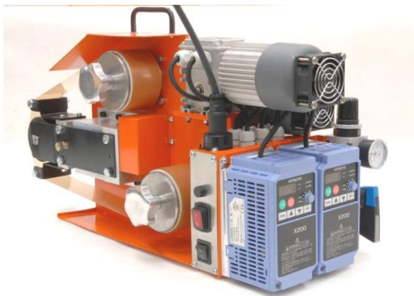
Rys. 21. Głowica typu GW-1 do mikrowygładzania zewnętrznych powierzchni walcowych foliowymi taśmami ściernymi
